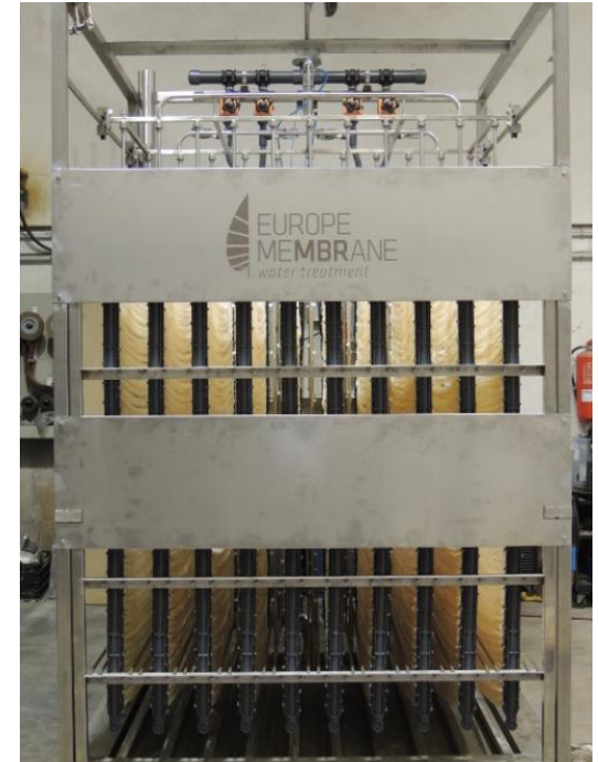
Membranas de ultrafiltración para bioreactores de membrana o para tratamientos terciarios
